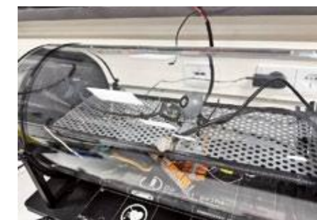
Reagiert der Sensor auf die Gase? Wie laut ist der Alarm, funktioniert der Selbsttest? Vier Tage prüfen die Tester die Funktionen der Geräte gewissenhaft.
